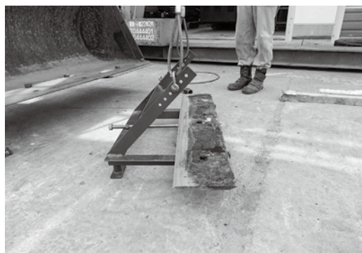
考案した治具にエッジ固定完了
