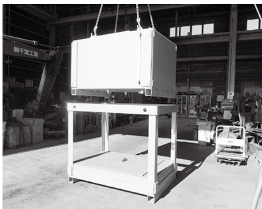
ベースウエイト2.9t(下)に追加積載ウエイト2.1t(上) (満水) 装着直前
