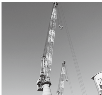
300t吊りジブクレーン
