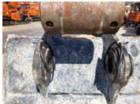
「治具」でOリングを固定したところ
