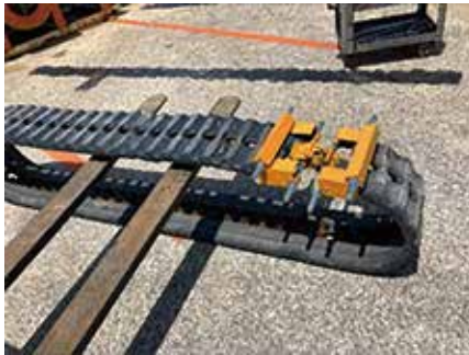
折損したゴムクローラに考案治具を装着したところ
