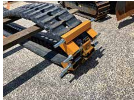
折損したゴムクローラに考案治具を装着したところ
