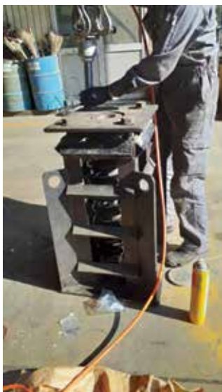
スプリングの上にプレートを乗せ ボルトを締付け固定
