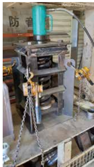
門型プレスに固定後、プレス で組立寸法迄押し付ける
