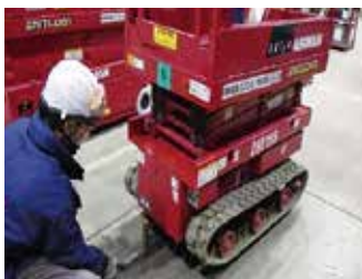
吊った機械の下に片手でスライド
