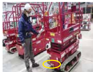
ストッパ(黄色印)が機械に触れたところで、機械を下す
