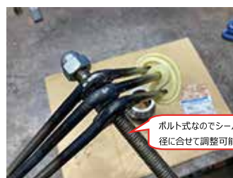
治具を使用してシールを折りたたんだ状態
